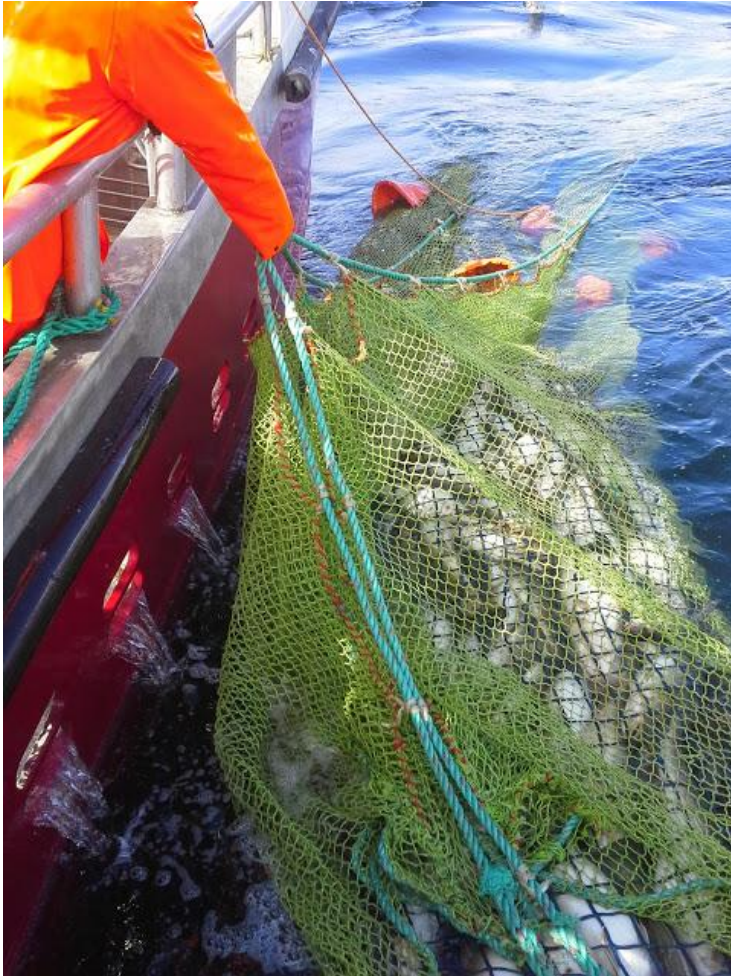
Figur 4. Fra forsøkene med Thea Dalwhinnie i juni 2014. Kvadratmaskesekk og dekknett før tømning.
